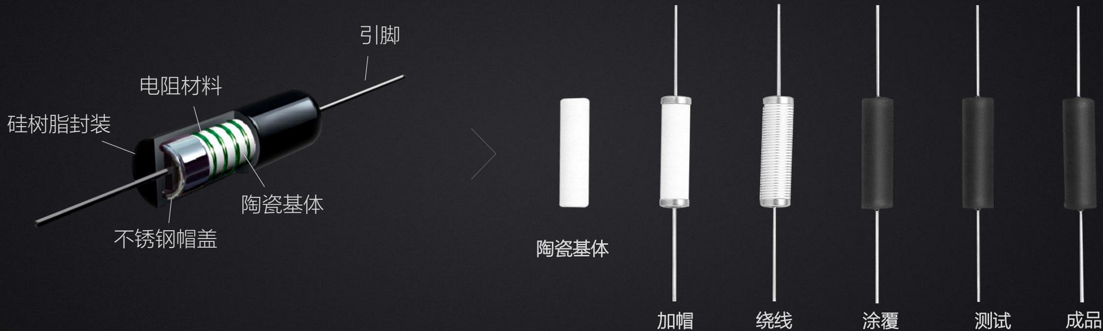
线绕电阻只有电阻合金丝是导电的部分，这些电阻合金丝的重量相对于整个电阻器而言只占很少的一部分，在受到短时高脉冲电流冲击的时候，热量没有时间通过绝缘基体和辅助散热器传导出去，所以这种电阻对瞬时的能量吸收有限，而且绕线电阻的寄生电感值比较大会影响脉冲的吸收时间。
