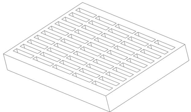
图 9-2. 包装所用 EPE 结构示意图
