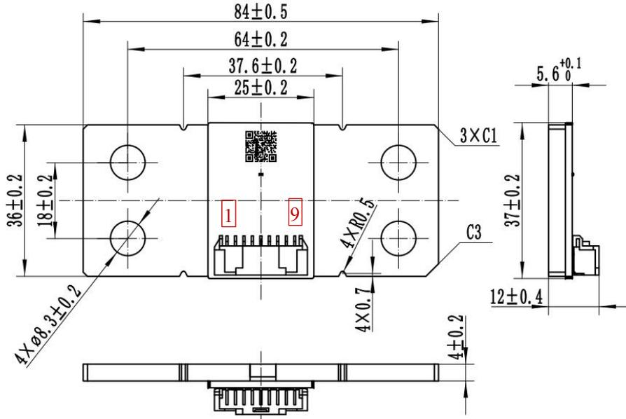
图 8-1. 电流检测模块结构示意图
