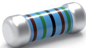
在当前大部分专业的电子应用中,如果对额定功率,抗脉冲能力及可靠性,稳定性等方面有较高要求的话,PMER电阻产品会是一个非常好的选择。同矩形贴片电阻比较,由于PMER独特的圆柱形结构设计,在相同的贴片封装尺寸下,PMER电阻的金属薄膜层面积是矩形贴片电阻的3.14倍,这使得PMER电阻可以承受相对更高的功率。
